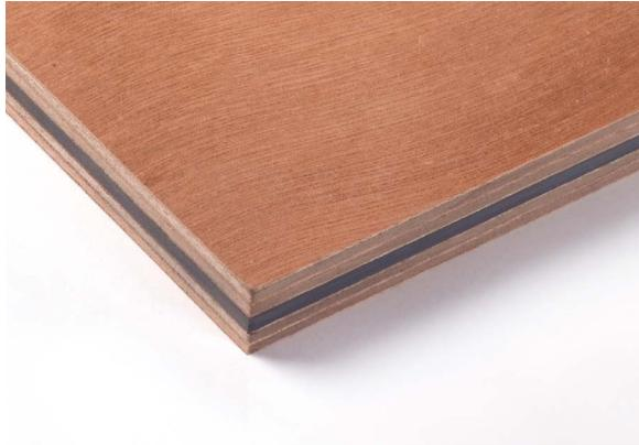
TRAINPLY CPP est un panneau sandwich, acoustique et ignifugé, composé d'une âme masse lourde de 3mm entre 2 panneaux de contreplaqué Okoumé/Ozigo.
